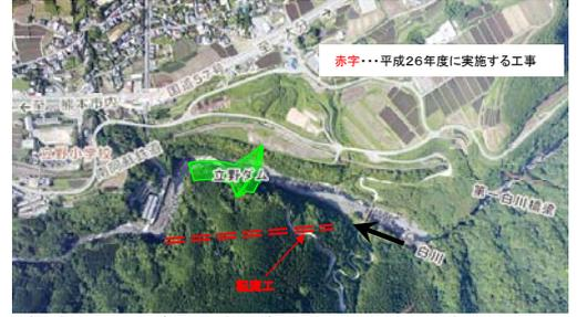
転流工とは、ダム本体工事を行うために、一時的に川の流れを切り替える工事です。
