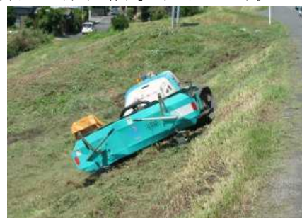
写真 4.3.2 遠隔操作による堤防除草作業
