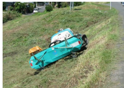
写真 4.3.2 遠隔操作による堤防除草作業
