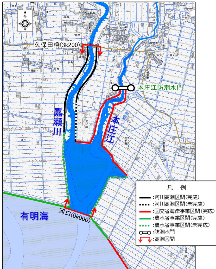
図 2.1.8 高潮堤防状況（令和 6 年（2024 年）3 月現在）
