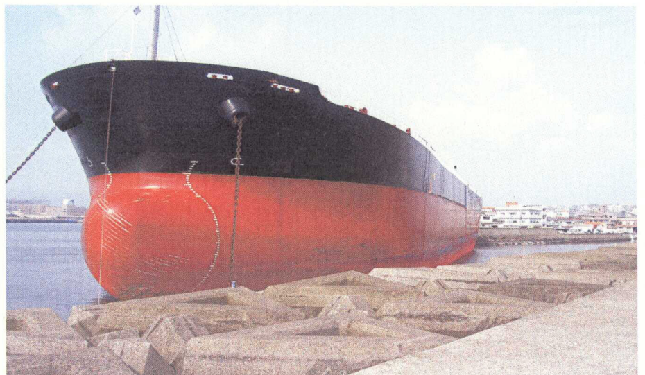
④【鹿児島県鹿児島港 中央港区】 建造途中の完成時5万トン級船舶が、錦江湾中央部に避泊していた。台風の影響により、ロープが切れ漂流し、新川河口部に河口を塞ぐ形で座礁して、護岸の一部(消波ブロック)を損壊した。
