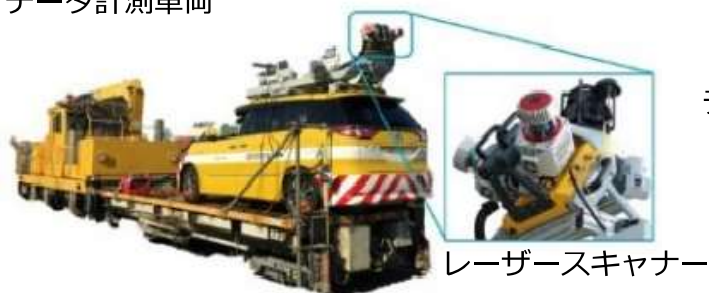
道路用のデータ計測車両を鉄道台車に搭載し、けん引
