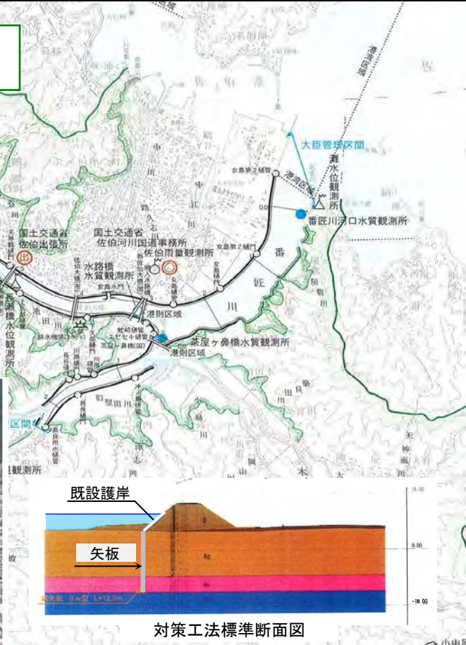
堤防強化対策工範囲(稲垣地区)
