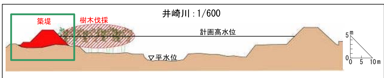
図 4.2.7 築堤・河道掘削等イメージ
