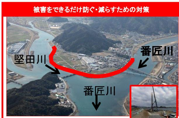
国:大規模地震発生時の堤防沈下対策
