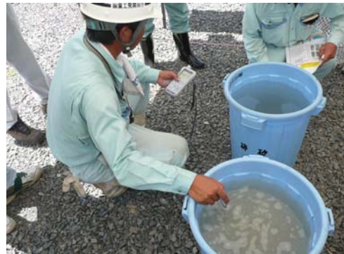
【水中不分離コンクリート(濁水対策)のPH試験】
