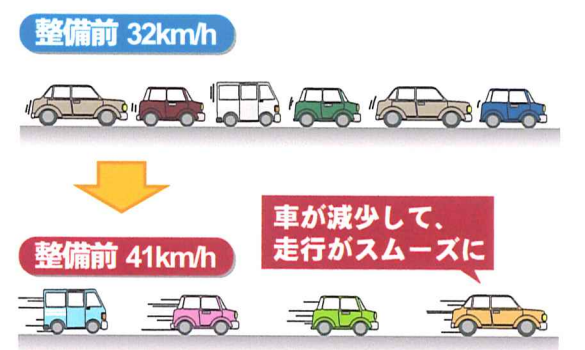
■平日夕方ピーク時の旅行速度の変化 資料：国道202号旅行速度調査結果より
