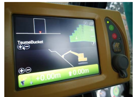
MCバックホーによる切土法面整形
