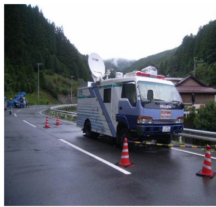
衛星通信車・Ku-SATからの映像配信
