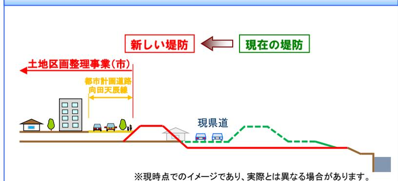
県道迂回路横断面図（施工イメージ）
