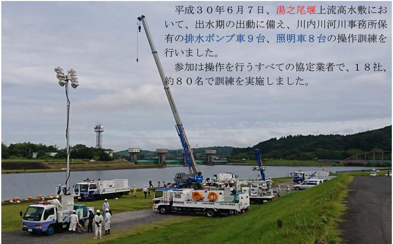
協定業の迅速な対応により、ポンプ設置、実排水が行われ、万全の体制を敷いて川内川流域の出水に備えます。
