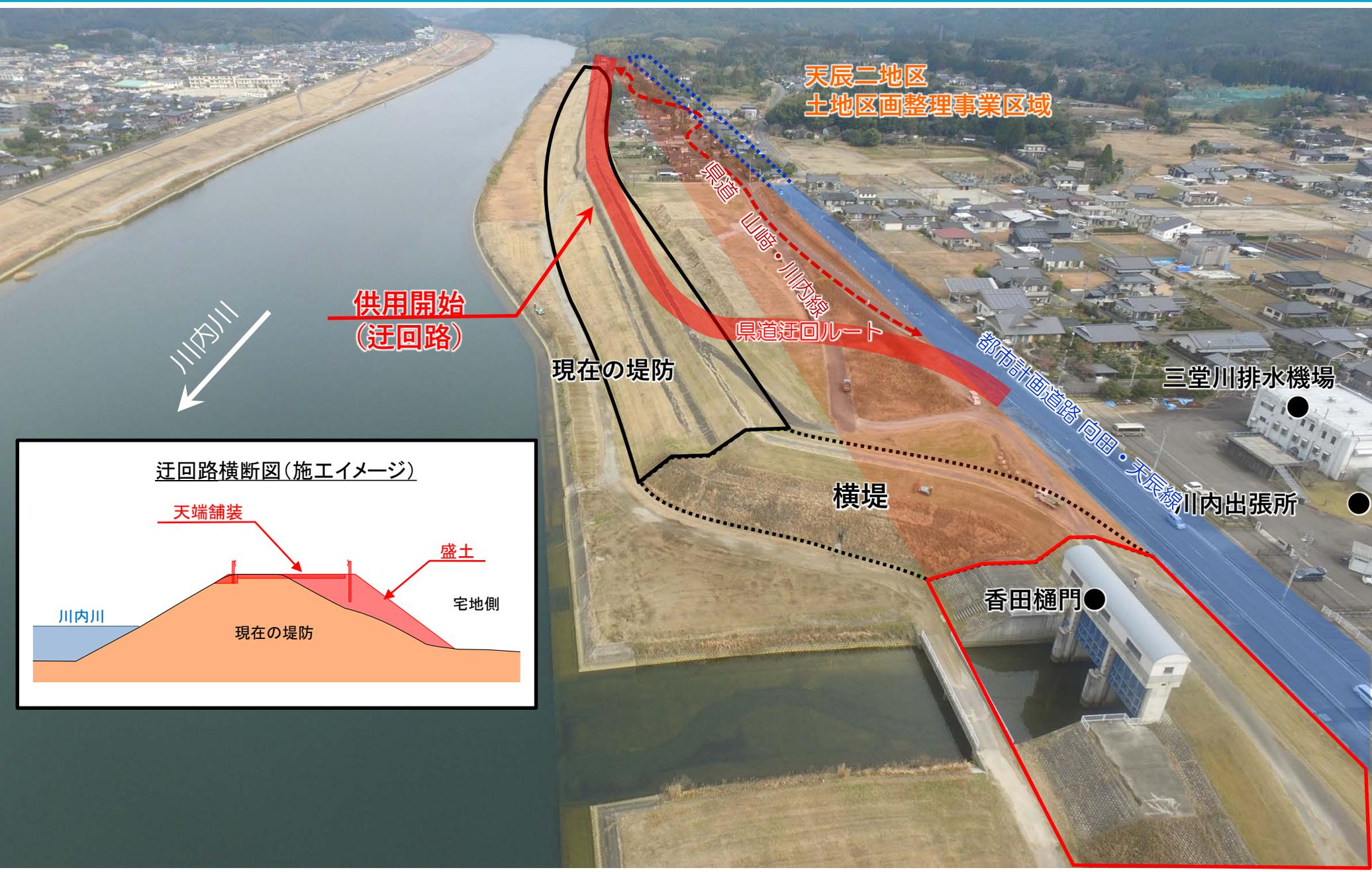
迂回路横断面図(施工イメージ)
