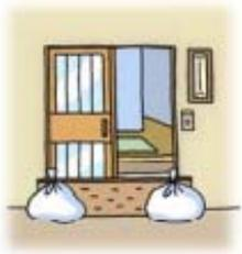
長めの板と土のうで臨時的止水板を作る。
