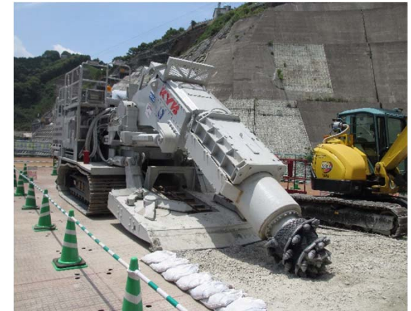
掘削機(穴をあける機械) ＜ブームヘッダー＞
