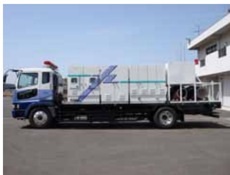
写真 2.1.4 排水ポンプ車
