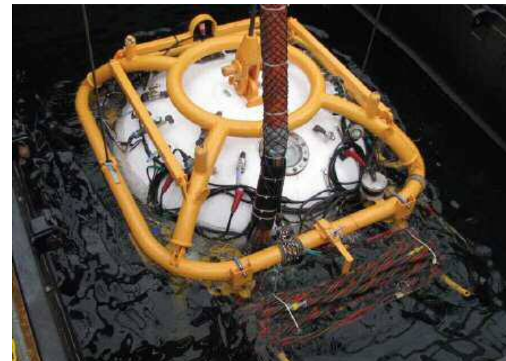
S.D.C. (submersible decompression chamber)
