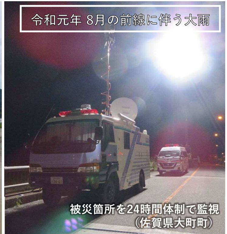
被災箇所のリアルタイム映像を配信する衛星通信車 (佐賀県大町町)
