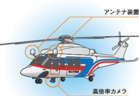
ヘリサットは機外に衛星通信用のアンテナ装置と防振機能を備えた高倍率カメラ、機内に映像伝送装置などを備えています。高倍率カメラにより上空から撮影した映像は、機内でデータ化されリアルタイムで通信衛星に伝送されます。
