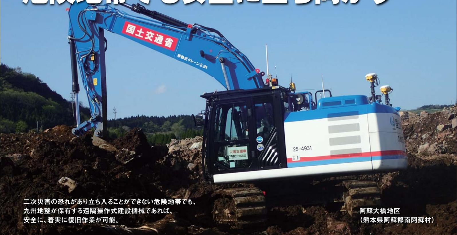
二次災害の恐れがあり立ち入ることができない危険地帯でも、九州地整が保有する遠隔操作式建設機械であれば、安全に、着実に復旧作業が可能。
