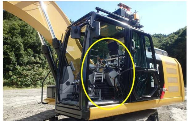
重機に遠隔操縦装置を設置した様子
