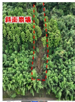
至霧島市 至鹿児島市 国道上部斜面の崩壊状況
