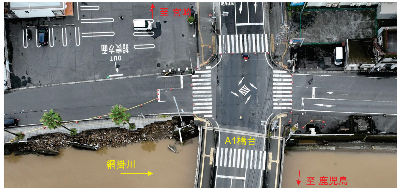
◆写真②(A1橋台下流側護岸損傷)
