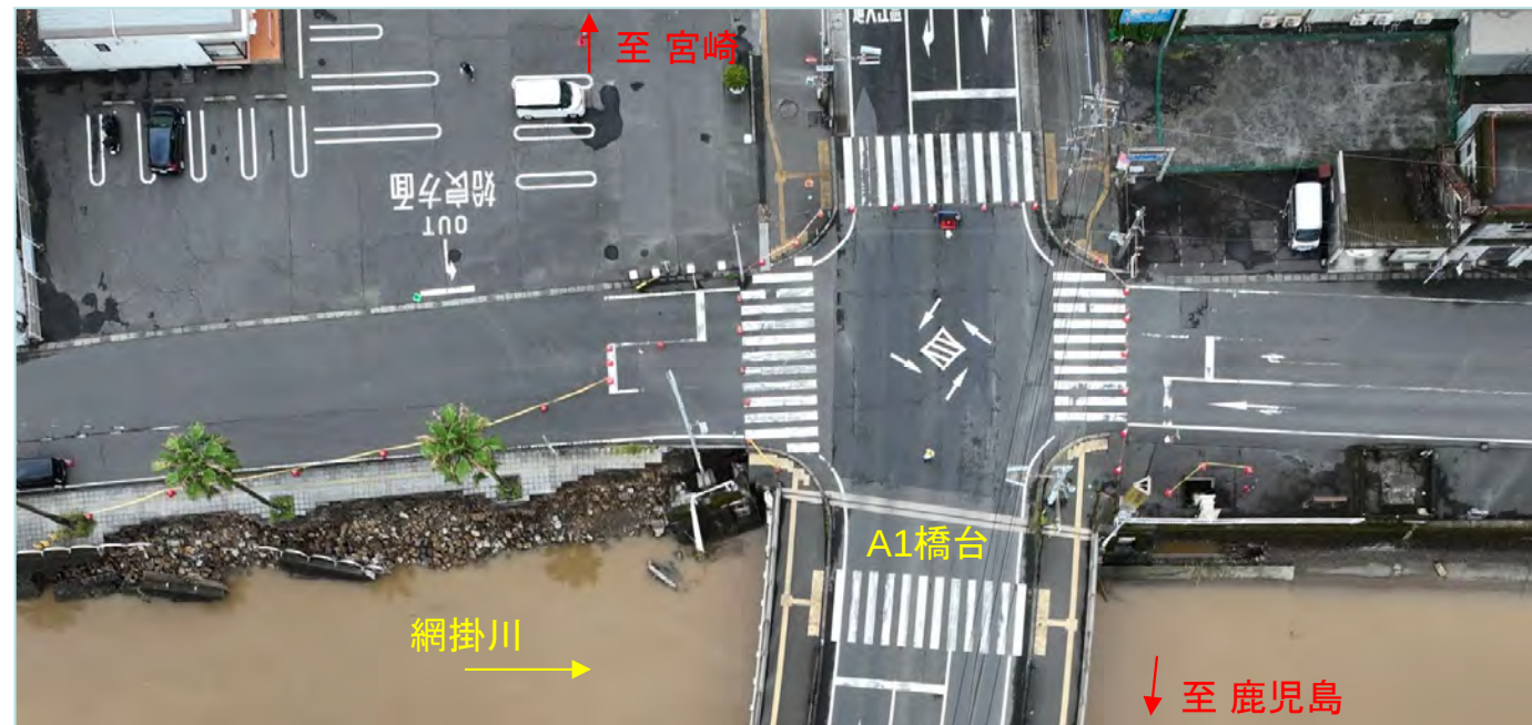
◆写真②(A1橋台下流側護岸損傷)
