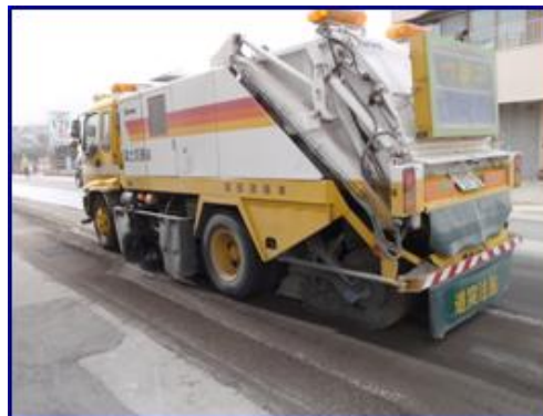
路面清掃車(作業中)
