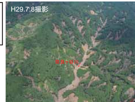
H29.7.8撮影 奈良ヶ谷川上流の崩壊状況(変成岩類が主)
