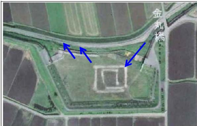
河道内貯留施設の配置イメージ
