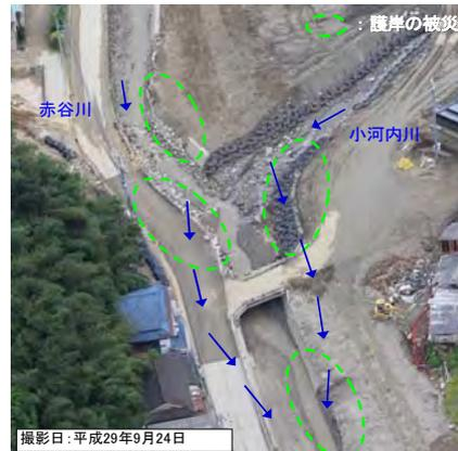
図 6.3.34 橋梁の被災状況（赤谷川：小河内橋）
