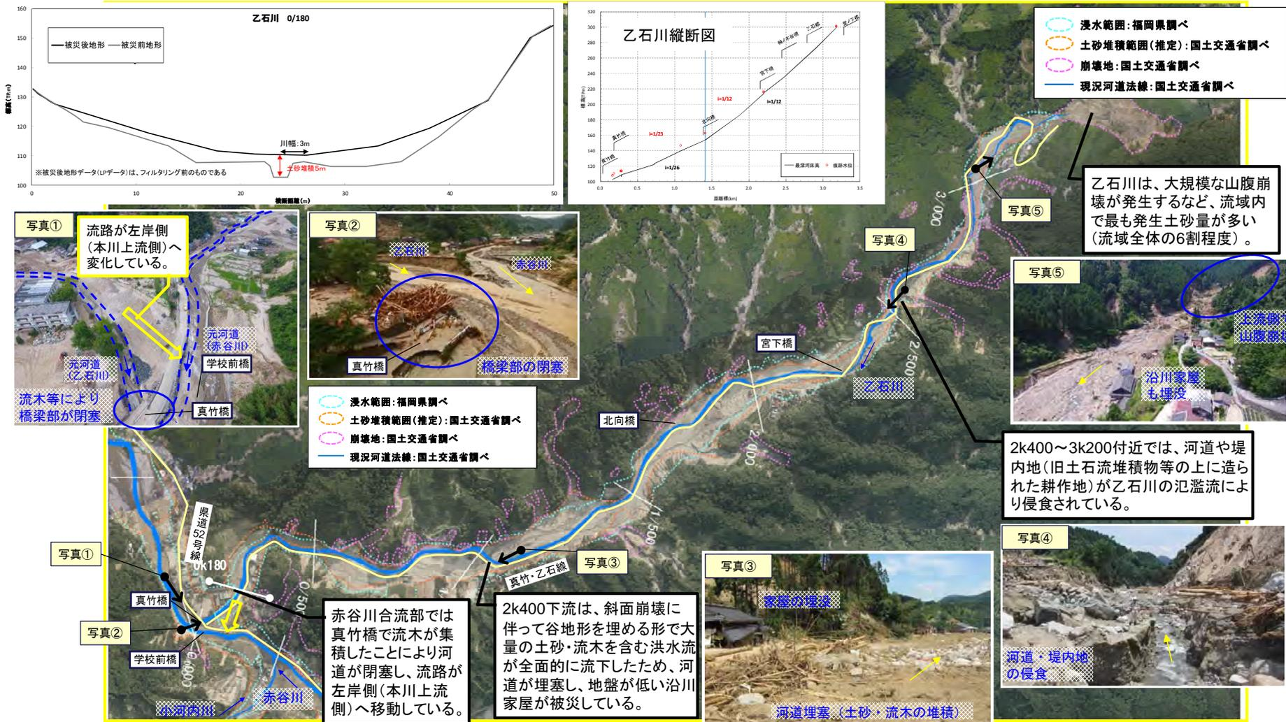
図 6.3.29 区間別の被害の特徴(乙石川 0k000~3k200)
