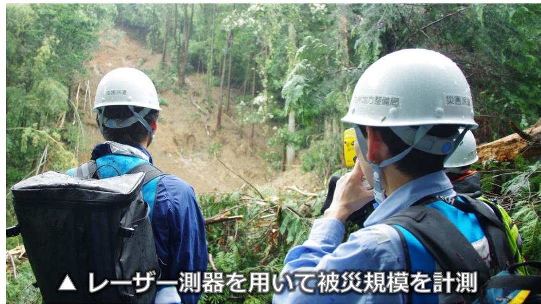
▲ レーザー測器を用いて被災規模を計測
