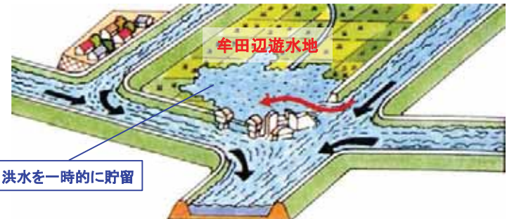
牛津川が大きな洪水となり、水位が高くなったときには牛津川の水の一部が遊水地内に入り、一時的に貯留され、牛津川の洪水を減らします。
