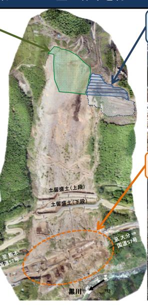
大分側凸部の緩み土塊を除去をしています。 (法面全11段のうち8段目を掘削)
