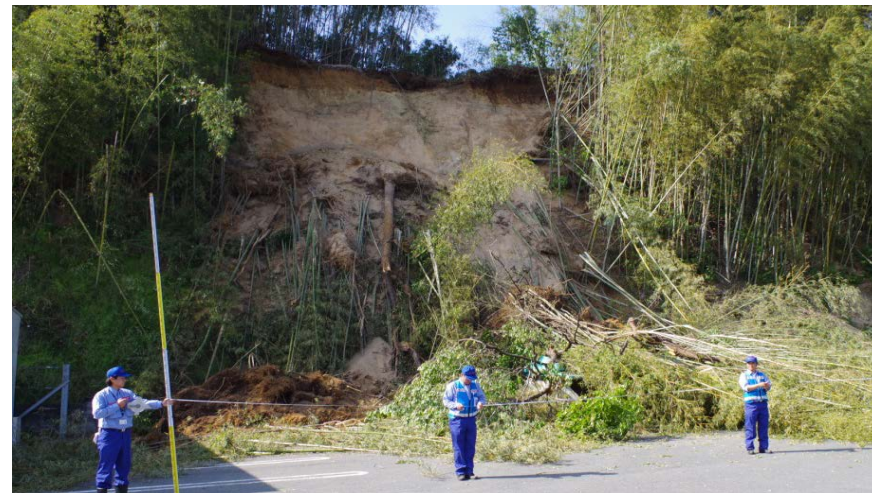
▲ 法面崩壊箇所を調査
