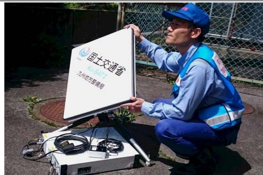
▲ 南阿蘇村役場にKu-SAT（衛星通信装置）を設置
