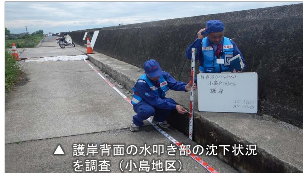
▲ 護岸背面の水叩き部の沈下状況を調査(小島地区)
