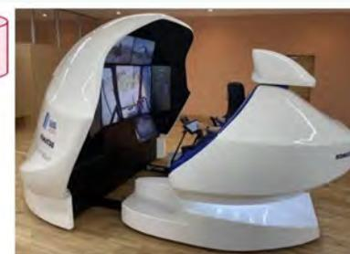
建設機械向けの遠隔操作システムを提供開始(株式会社小松製作所HPより)
