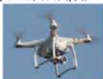
UAV(ドローン等)による3次元測量
