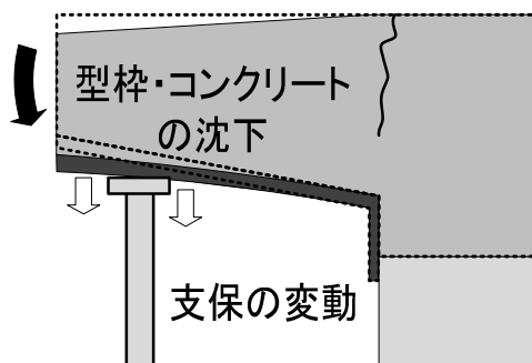
図 3-3.3 沈下によるひび割れ例
