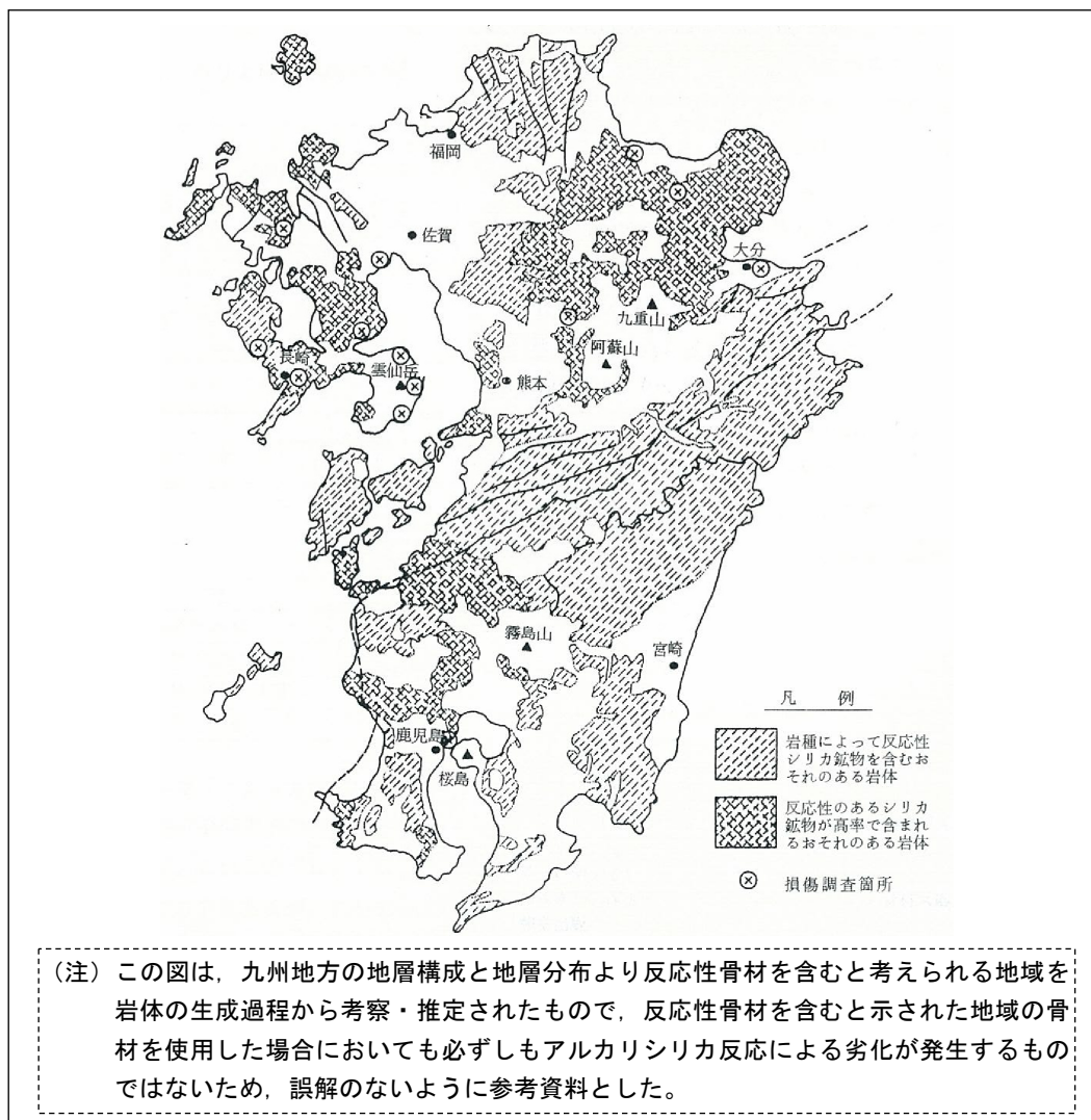
図 1.4 九州地方における反応性骨材の分布推定図 (出典：九州技報第 8 号)
