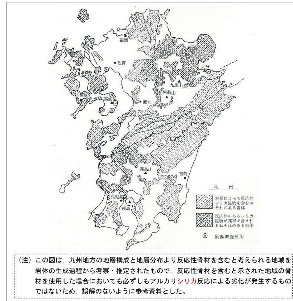
図 1.4 九州地方における反応性骨材の分布推定図
