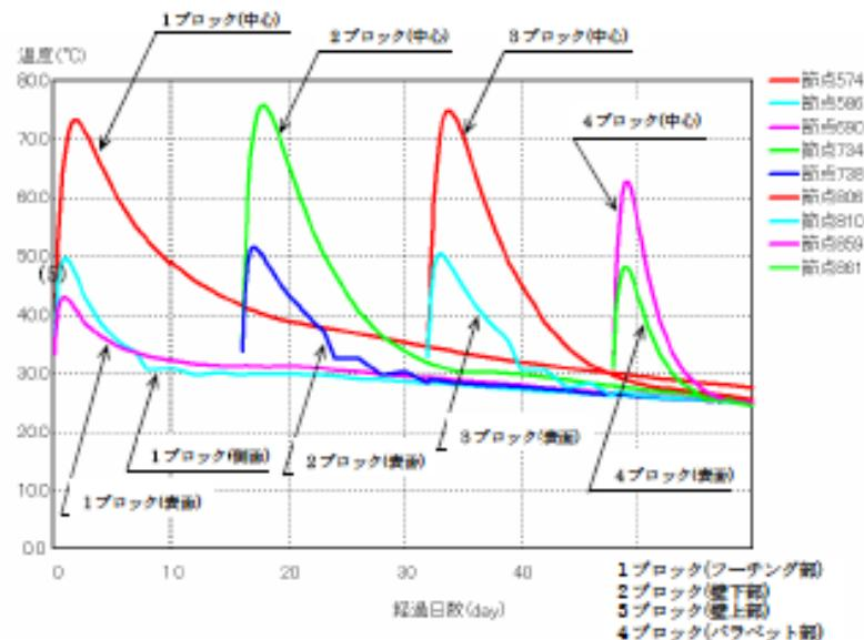
図 2-4 コンクリート温度の経時変化
