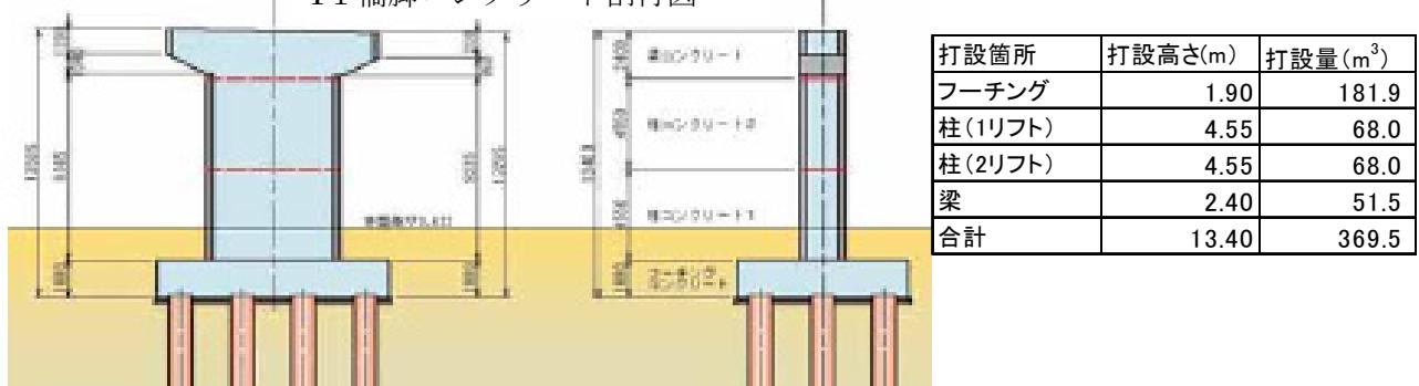
図 2-2 P2 橋脚コンクリート割付図
