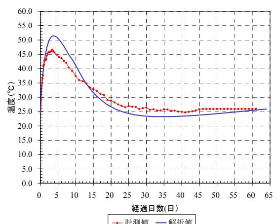
図3－5 堰柱③中央部の温度分布図
