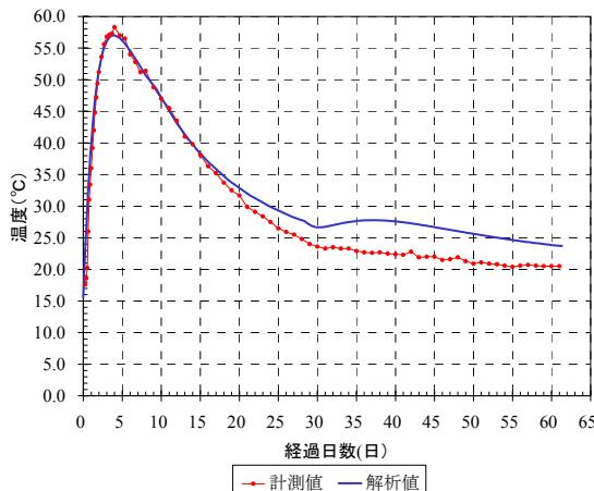
図3－2 底版中央部の温度分布図
