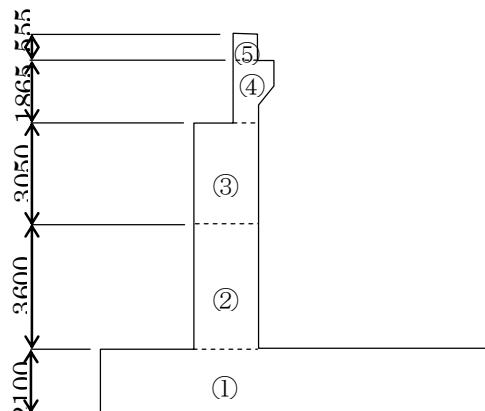
図3-1 A2橋台コンクリート割付図
