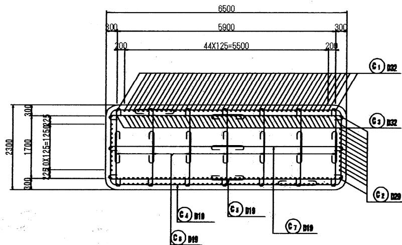
なお、帯鉄筋は 125mm ピッチで配置し、中間帯鉄筋に関しては鉄筋量の算定から除外した。
