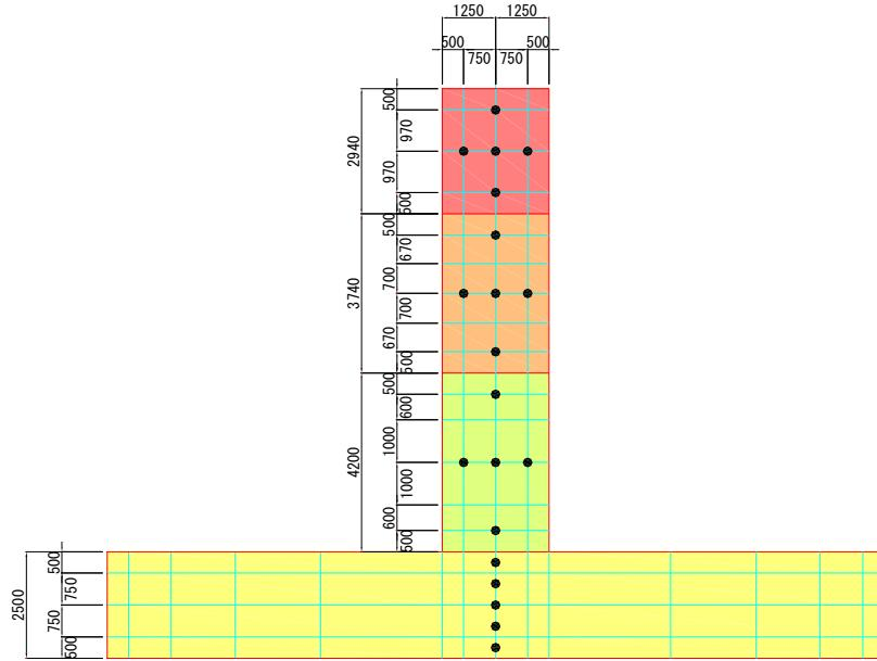
図 2-1 堤柱検討正面図（右岸堤柱）
