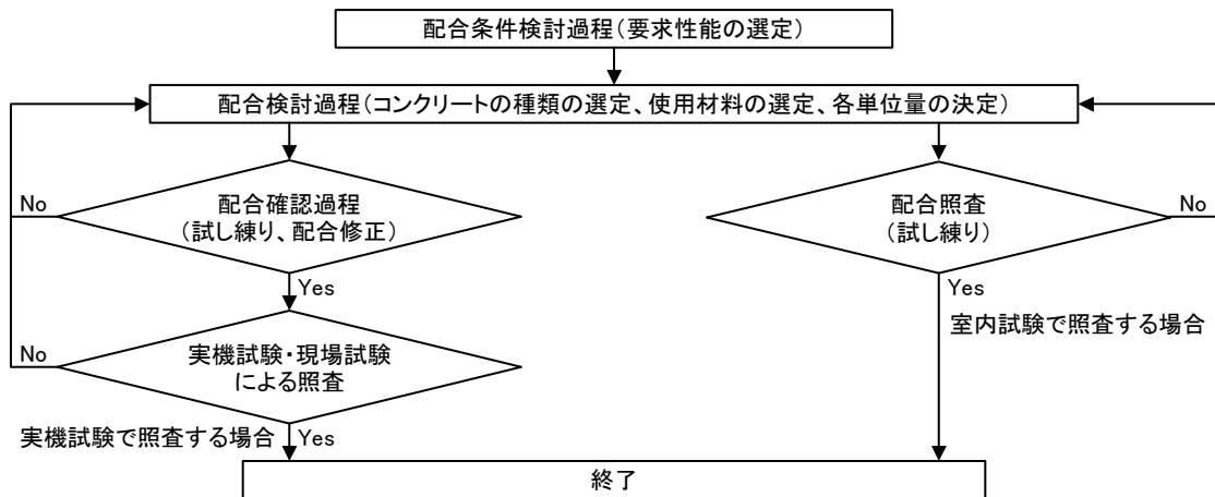
解説 図4.7.1 高流动コンクリートの配合設計フロー
