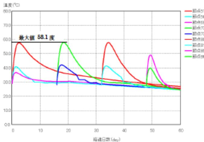
図 2-9 コンクリート温度の経時変化（低熱高炉セメント）
