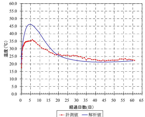
図3－3 堰柱①中央部の温度分布図
