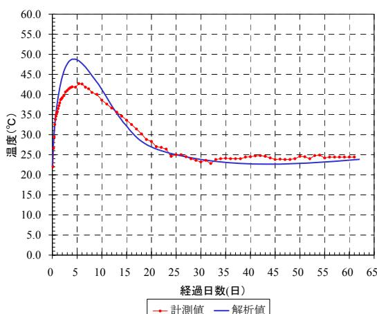
図3－4 堰柱②中央部の温度分布図
