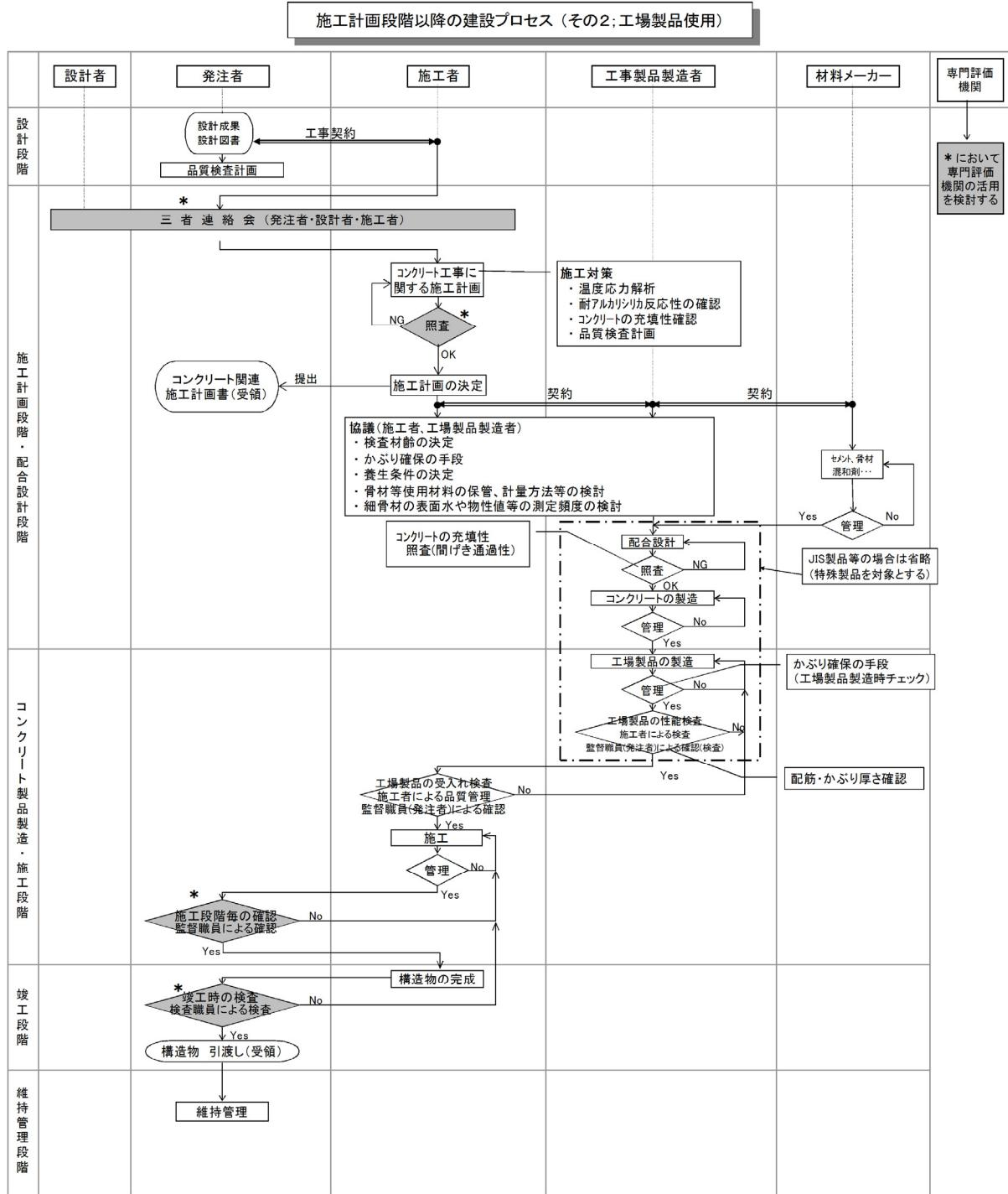
**解説 図 1.2.4 施工計画段階以降における建設プロセス
