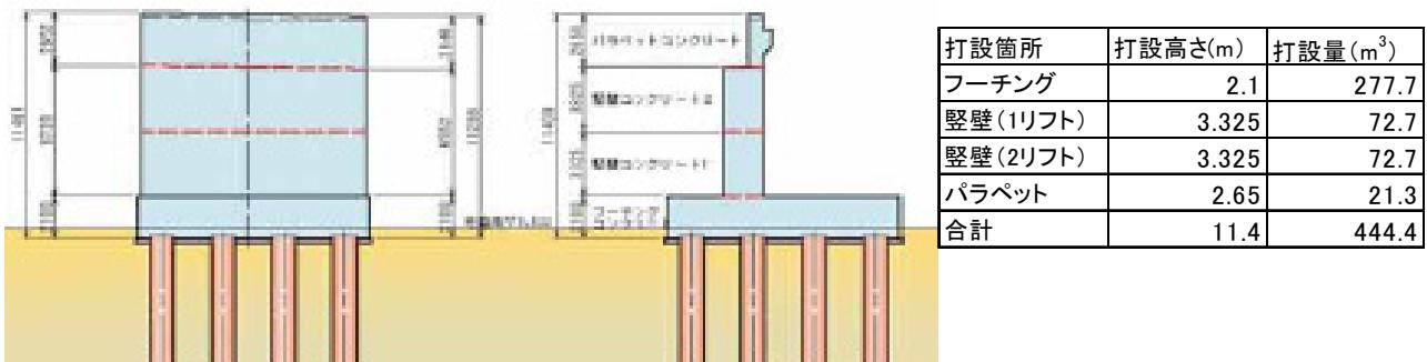
図 2-1 A2 橋台コンクリート割付図
