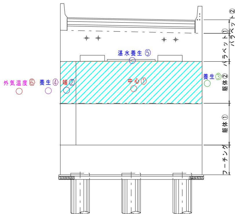
図4-3 車体②計測位置図
