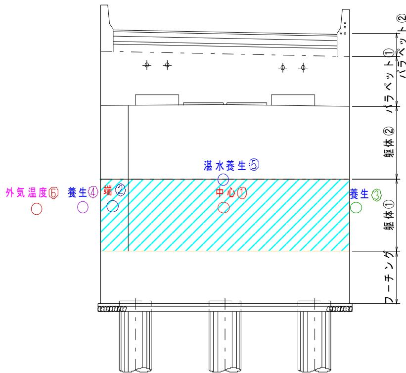
図4-2 車体①計測位置図
