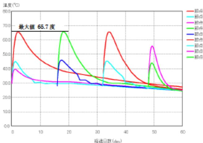
図 2-8 コンクリート温度の経時変化（高性能 AE 減水剤）
