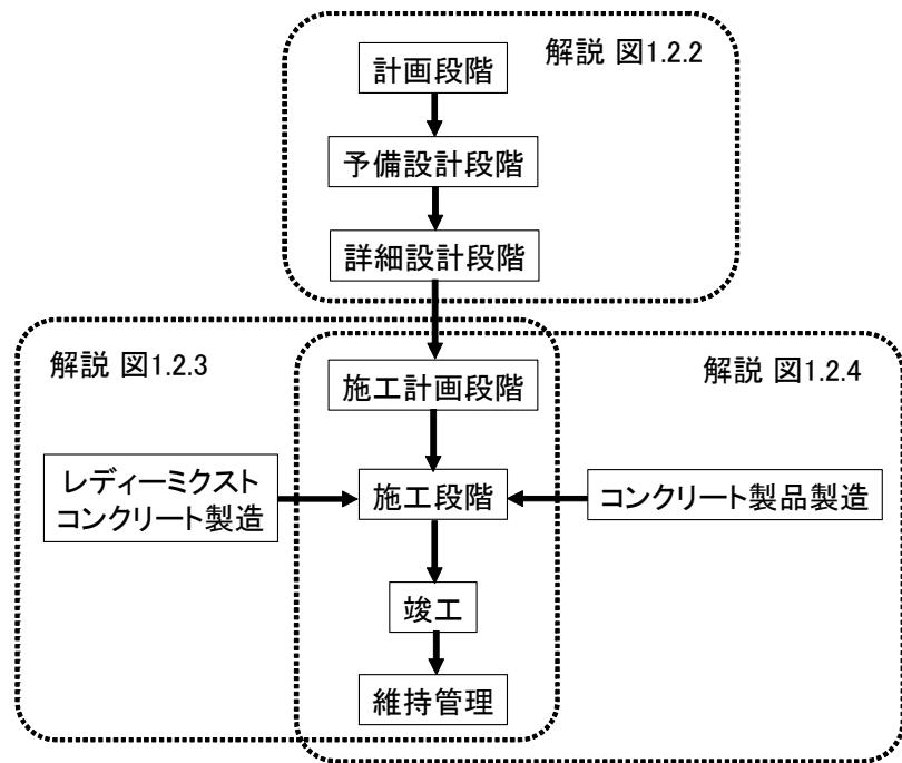
解説 図 1.2.1 建設プロセスの概略
