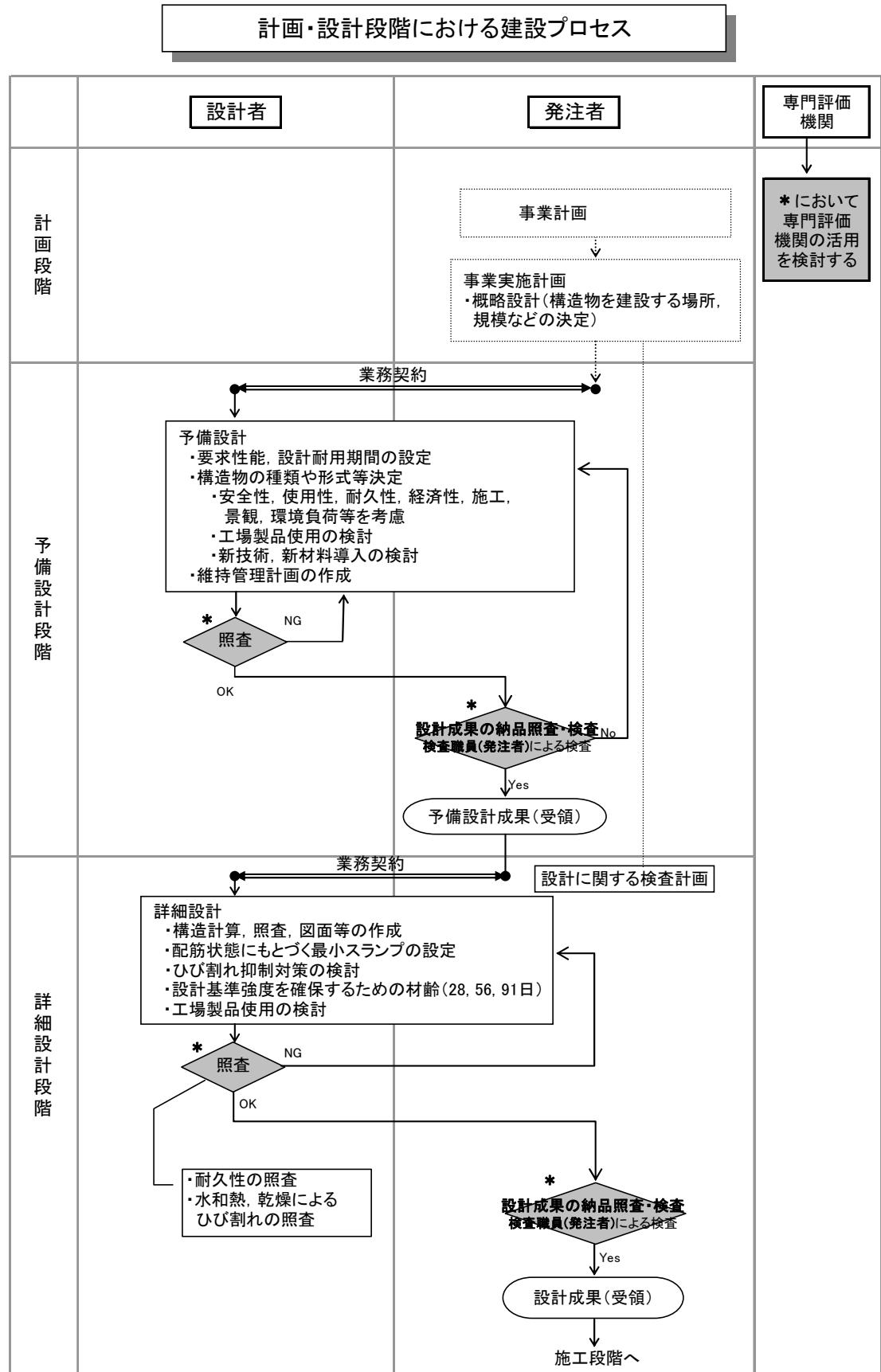
解説 図 1.2.2 計画・設計段階における建設プロセス
