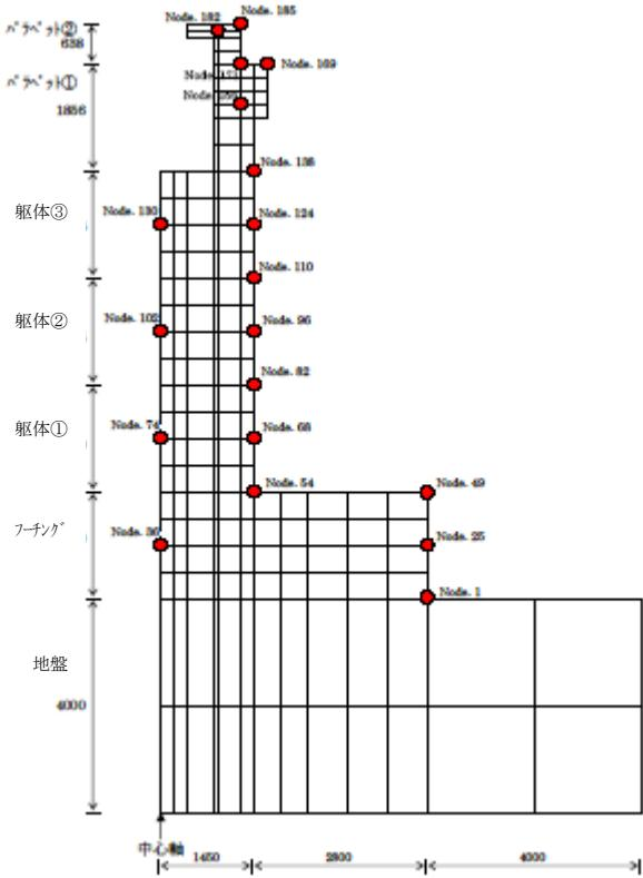
図 3-2 解析モデル図 Case2, 4, 5, 6, 7, 8
