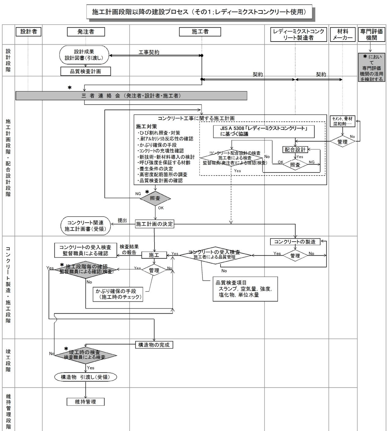
解説 図 1.2.3 施工計画段階以降における建設プロセス
