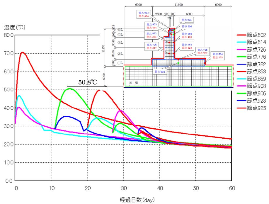
図 3-6 コンクリート温度の経時変化（対策条件）
