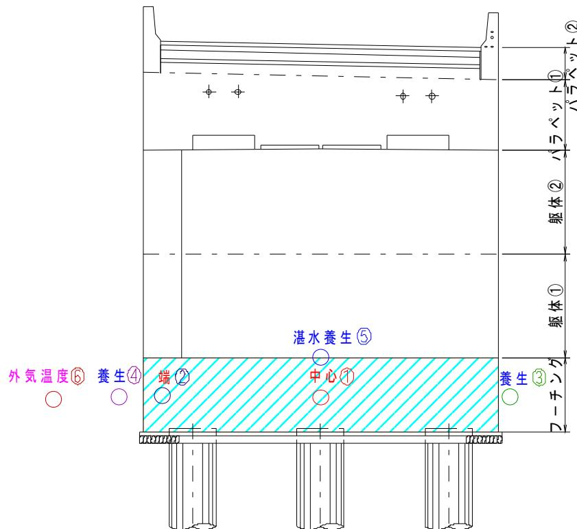
図 4-1 フーチング計測位置図
