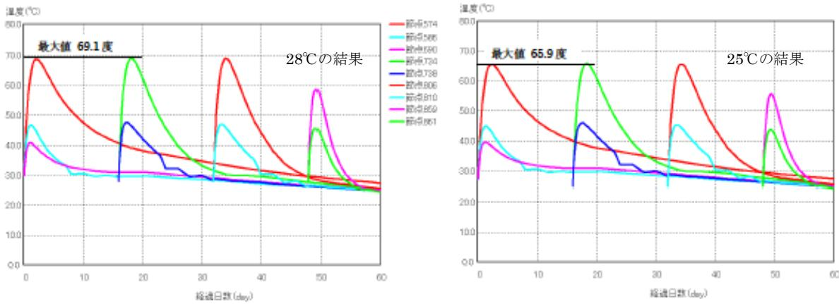
図 2-7 コンクリート温度の経時変化（プレクーリング）
