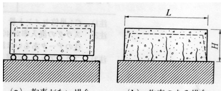
ii ) 外部拘束によるひび割れ（壁状構造物）
