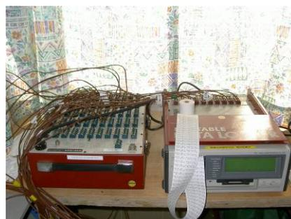
写真 3.7.1 温度測定機器設置例
