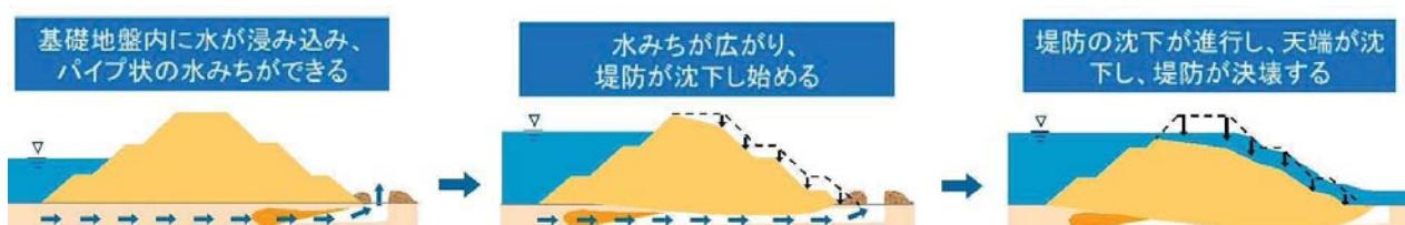
図 3.1.2 パイピング破壊による堤防決壊のイメージ図
