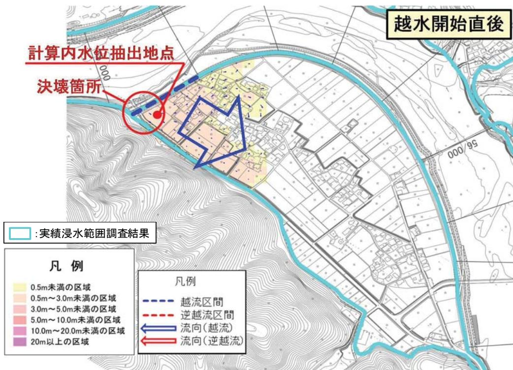
図 3.5.7(1) 汚濫解析結果による大柿排水樋管地点の氾濫状況(越水開始直後)
