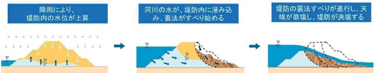
図 3.1.3 浸透破壊による堤防決壊のイメージ図
