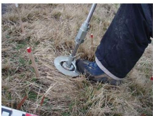
写真 I-2-8 トルク計先端部設置状況
