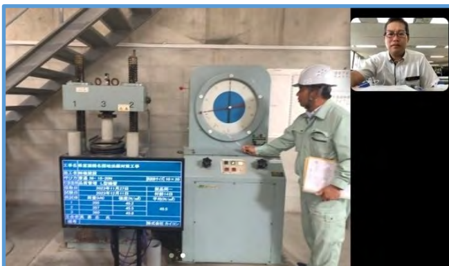
【圧縮強度試験 立会状況（工場側）】
