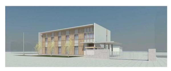
画像中央が庁舎。庁舎の背後にある平家建てが車庫倉庫 CLTの使用予定部位:庁舎の壁、2階床、屋根の構造材、玄関庇等 イメージ図※1
