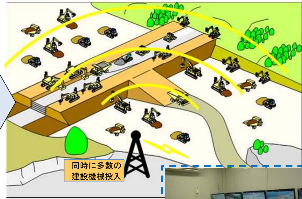
5Gを活用した無人化施工イメージ
