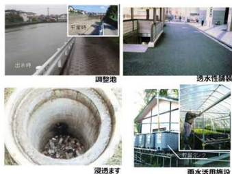
雨水貯留浸透施設の例
