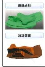
起工測量による3次元測量データ（現況地形）を活用し、設計図面との差分から、施工量を自動算出。
