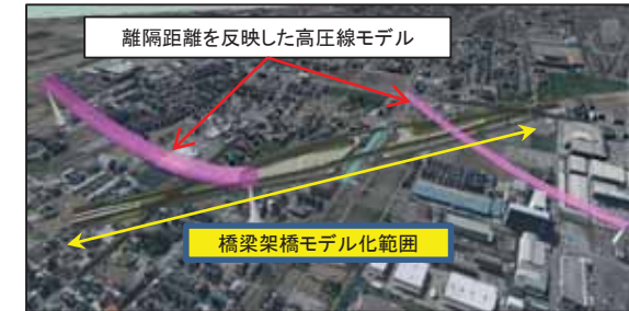
橋梁と架空線の離隔確認
