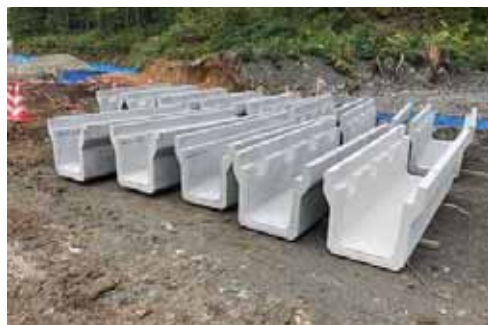
成瀬ダム付替道路で実証中のCO2を固定するコンクリート（U字溝）
