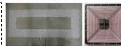
型枠実験用コイル (左: 道路側) 受電コイル (右: 車体側)
